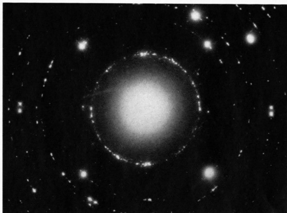
Abb. 4. Interferenzen einer Germaniumschicht, die bei Zimmertemperatur auf eine Steinsalzspaltfläche aufgedampft und abgelöst wurde. Die durchstrahlten Kristallite waren vorher von einem Elektronenstrahl aufgeheizt worden.
