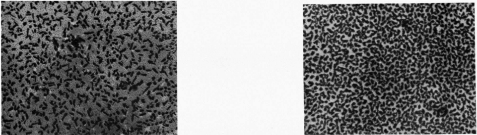
Abb. 2. Elektronenmikroskopische Aufnahme einer kristallinen (links) und einer amorphen (rechts) Se-Schicht, auf Formwar aufgedampft (Dunkelfeldbeleuchtung, Vergr. 5000\times 2 , d_w = 320 \text{ \AA} ).
